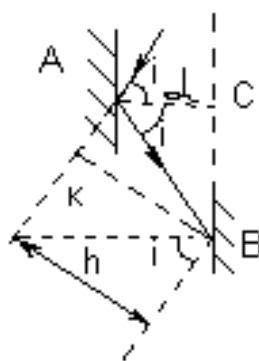
Рис. 4.4. Зміщення променя двома паралельними дзеркалами
