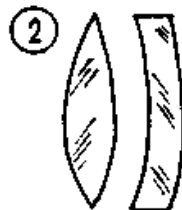
Рис.3.2 Дволінзовий об'єктив з повітряним проміжком
